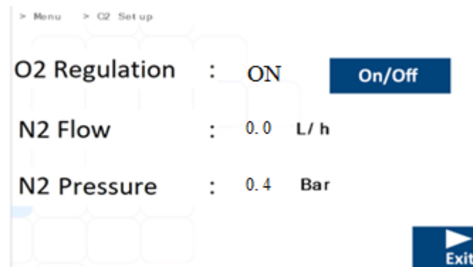
Figure 13.26 Affichage du sous-menu de configuration du O 2 de l'incubateur pour FIV à compartiments MIRI® TL6 et MIRI® TL12
