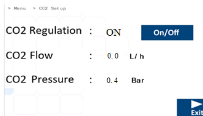
Figure 16.2 Affichage du sous-menu de configuration du CO 2 de l'incubateur pour FIV multiroom MIRI® TL6 et MIRI® TL12
