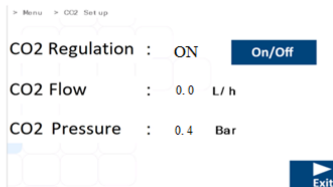
Figure 13.25 Affichage du sous-menu de configuration du CO 2 de l'incubateur pour FIV à compartiments MIRI® TL6 et MIRI® TL12
