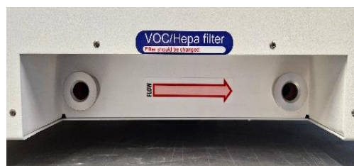
Figure 12.1 La flèche de flux sur les incubateurs de FIV MIRI® TL6 et MIRI® TL12 multirooms
